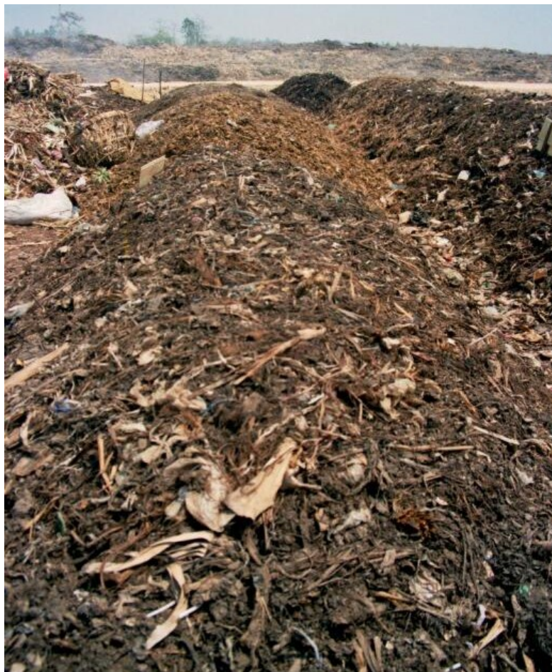
Bild 6: Längsmieten (18 m) auf der Kompostierungsanlage
