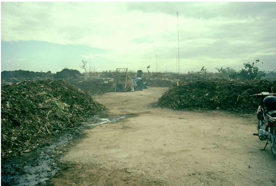
Bild 16: Sickerwasseraustritt aus einer frisch aufgesetzten Rottemiete
