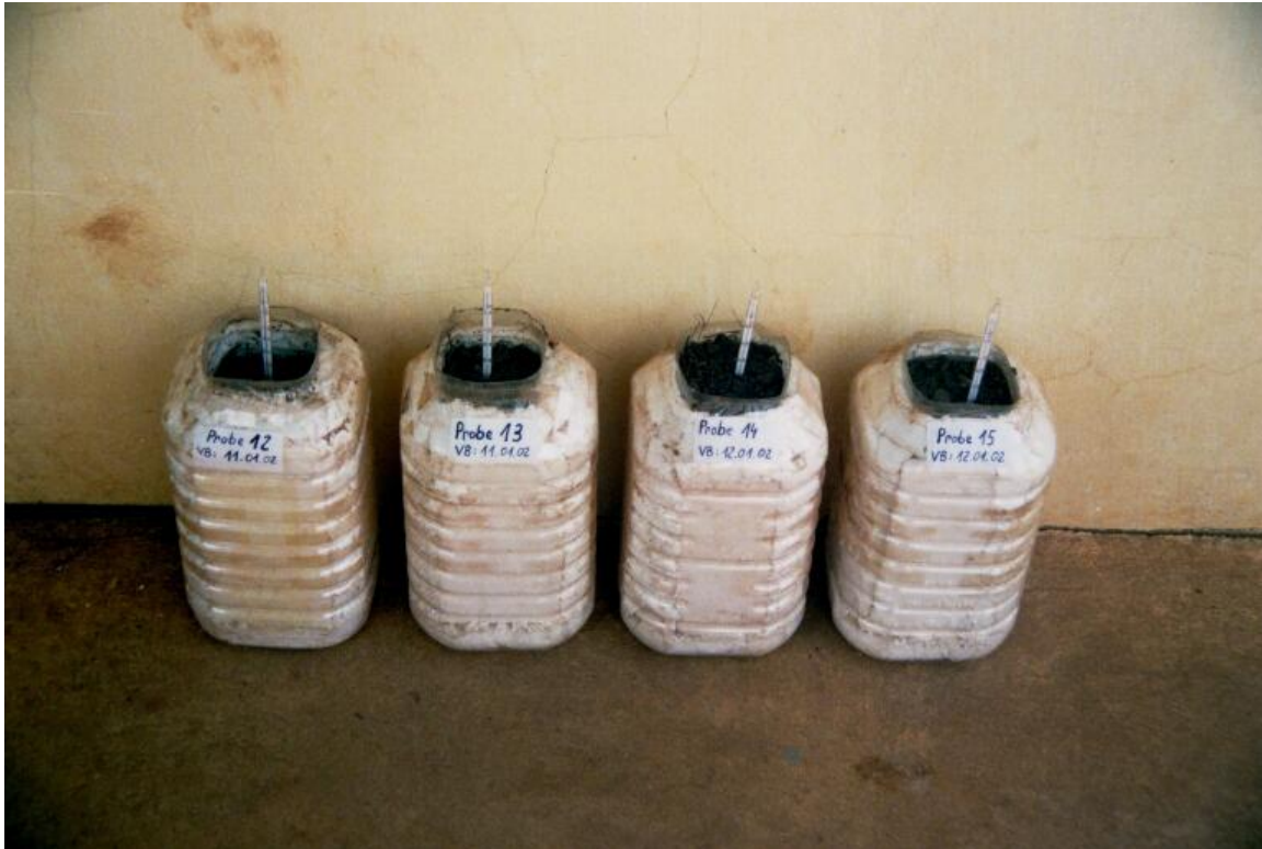
Bild 21: Bestimmung des Rottegrades im Selbsterhitzungsversuch mit Selbstgefertigten Dewar-Gefäßen und Thermometern
