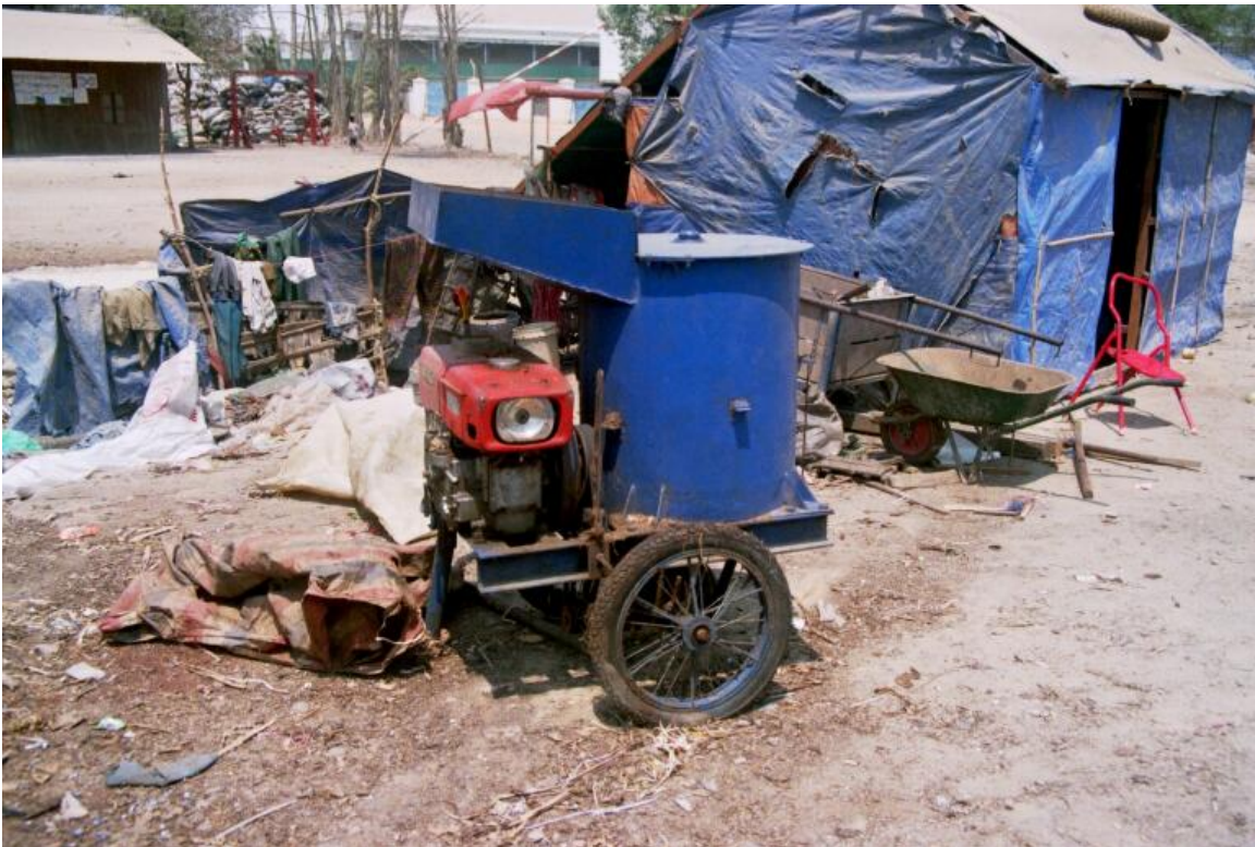
Bild 10: Shredder der Kompostierungsanlage
