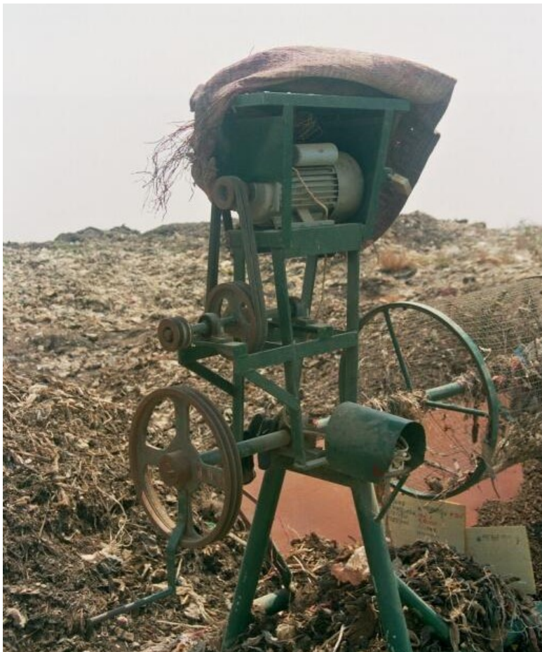
Bild 12: Elektromotor und Antriebsübersetzung bei der Siebmaschine
